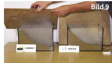
**Schritt 8:** Zuerst den Deckel vom Winter-Aquarium **ganz langsam** entfernen. Schnelle Bewegungen und Luftzug (z.B. offenes Fenster) vermeiden, sonst funktioniert das Experiment u. U. nicht. Dann auch den Deckel vom Sommer-Aquarium entfernen (Bild 9).
